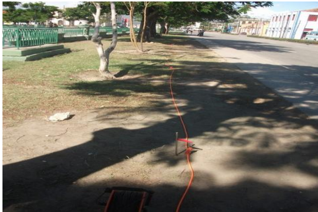
Fig. 3.7. Emplazamiento para el método de tomografía eléctrica en el área alrededor del edificio EMCOMED. Foto tomada por el autor.
