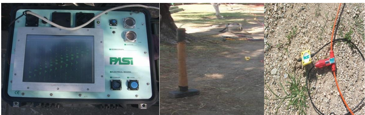
Fig. 2.1. Partes principales del equipamiento utilizado en la sísmica de refracción, desde izquierda a derecha: equipo de medición, mandarría y geófono. Fotos tomadas por el autor.
