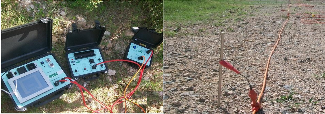
Fig. 2.2. Partes del equipamiento utilizado en la tomografía eléctrica, desde izquierda a derecha: equipo de medición, energizador, caja de conexiones, electrodo de acero y cable tomográfico. Fotos tomadas por el autor.
