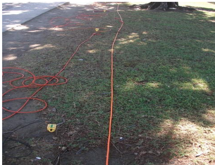
Fig. 3.6. Emplazamiento para el método de sísmica de refracción. Foto tomada por el autor.
