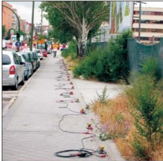
Fig. 1.4. Ejecución de mediciones sísmicas en Madrid (Análoga 2).
